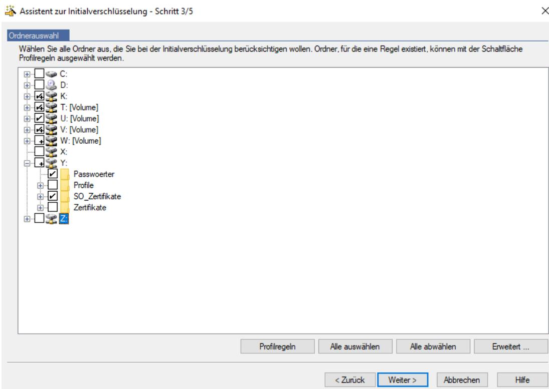
Ausgewählte Laufwerke und Ordner werden mit einem Häkchen markiert. Ein Häkchen mit einem zusätzlichen „+“ Zeichen bei einem Ordner zeigt an, dass sich darin noch weitere Unterordner befinden, die nicht bearbeitet werden, in denen also keine Verschlüsselung / Umschlüsselung der Dateien durchgeführt wird. Wenn diese auch bearbeitet werden sollen, sind diese per Mausklick ebenfalls mit einem Häkchen zu markieren.
